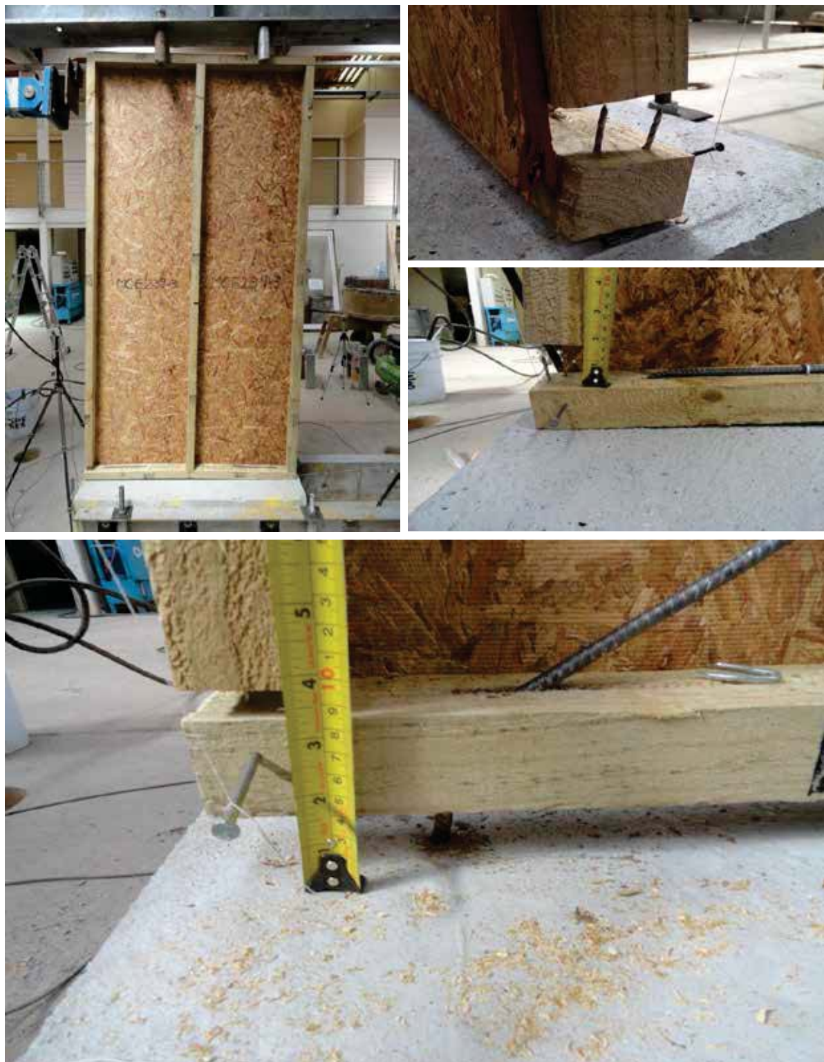
Figura 2.17: Modo de falla característico de ensayo de carga horizontal en muros con estructura de madera con sistema de anclaje espárrago
